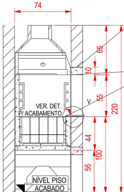
CORTE COM ALVENARIA DE FECHAMENTO A SER EXECUTADA APOS INSTALACAO DO KIT.
