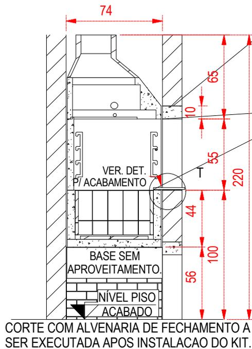
CORTE COM ALVENARIA DE FECHAMENTO A SER EXECUTADA APOS INSTALACAO DO KIT.
